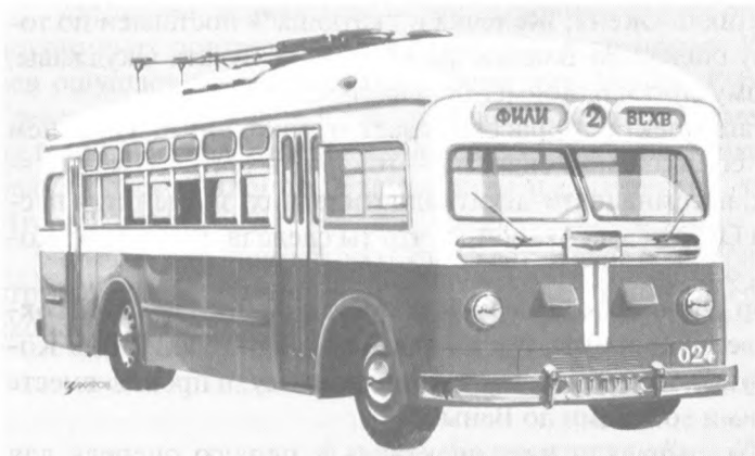
Троллейбус МТБ-82Д на рисунке Александра Захарова, сделанном для исторической серии "Из коллекции "За рулём"". Вагон был рассчитан на перевозку 65 пассажиров со скоростью до 47 км/час
